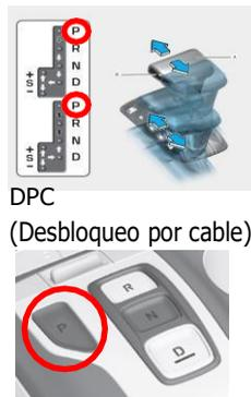
1. Calce las ruedas y tire del interruptor del freno de estacionamiento.
